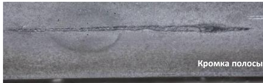
Рисунок 1.4 – Внешний вид раскатанного подкоркового пузыря на прокате
