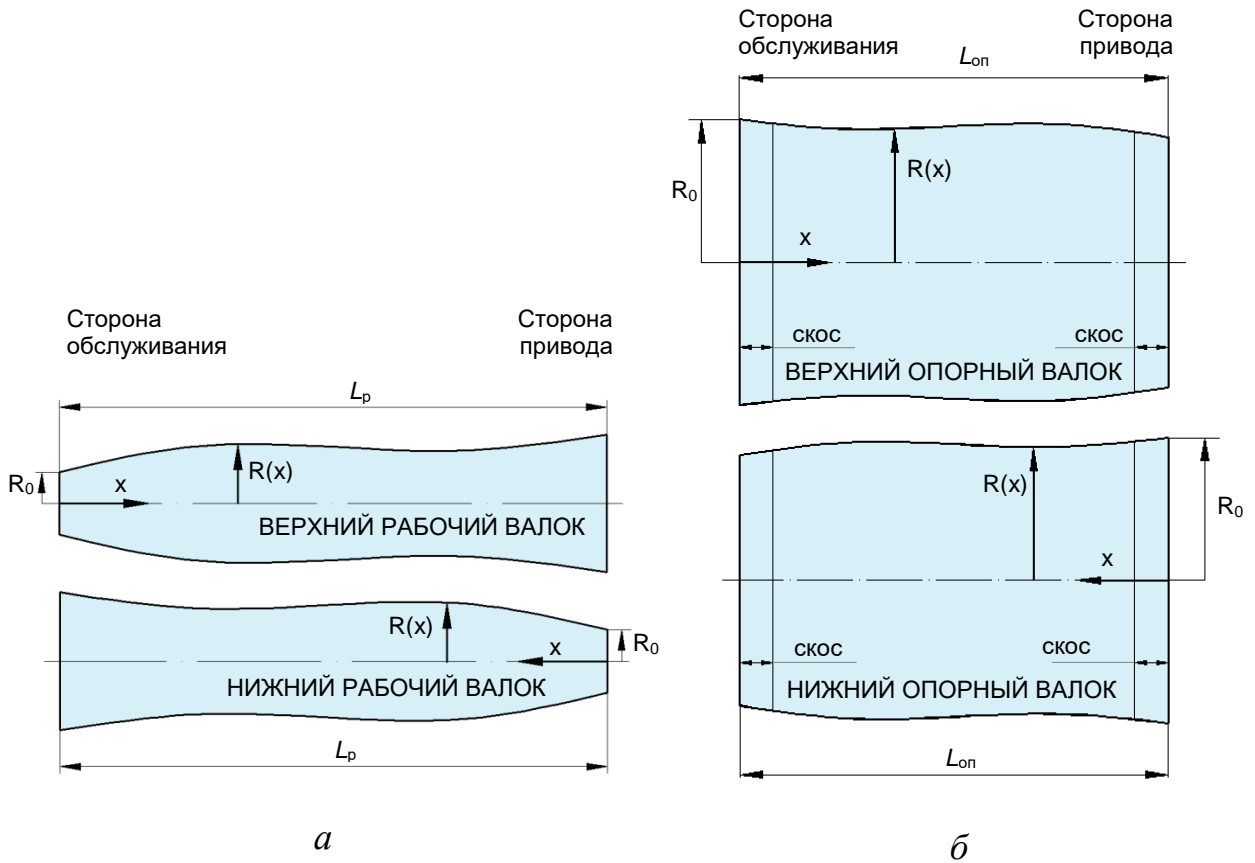
Рисунок 3.3 – Асимметричные выпукло-вогнутые профилировки бочек рабочих валков (а) и опорных валков (б):
