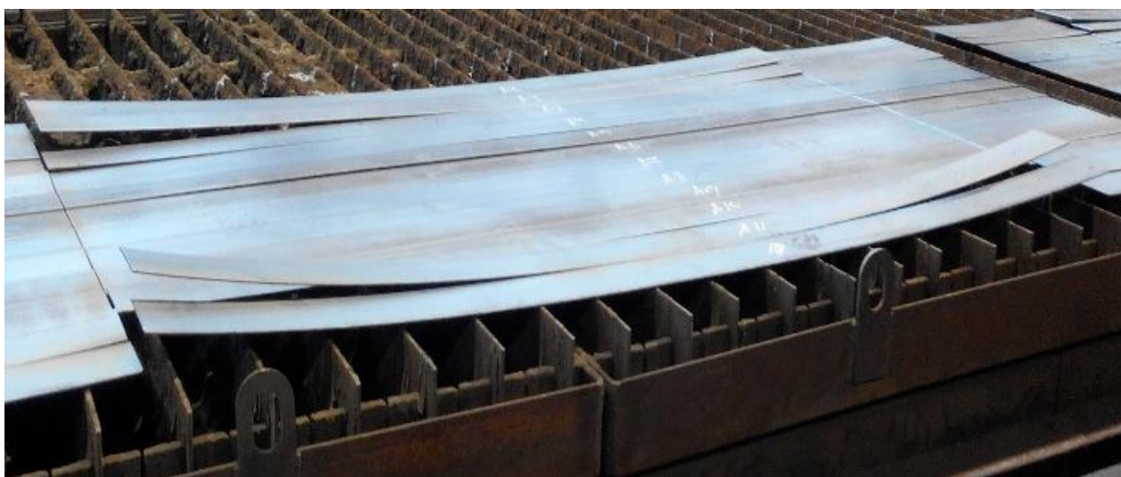
Рисунок 1.3 – Деформация горячекатаного листа после плазменной резки
